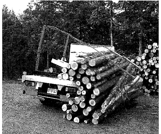
ダンプ装置で積み荷を下ろすことができる
